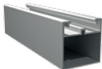
Hliníkový profil pre samonosné konštrukcie alebo k pripojeniu k podkladu (podporné body každých 70 cm) 50 x 50 mm
